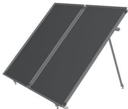
14: Colgar el segundo colector. (Medida A = medida B según la figura 14b). Utilizar calibre de montaje (14b).
