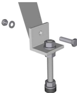
6c: Atornillar la escuadra de apoyo con el ángulo de fijación por detrás (C)
