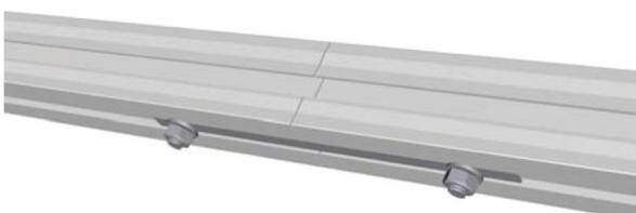
10: Introducir la regleta siguiente (arriba y abajo) y sujetar mediante la prolongación de la pieza de apriete.
