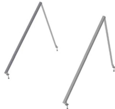
6d: Montar el segundo triángulo de fijación según 6a - 6c
