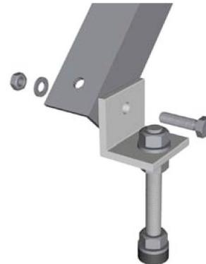
6b: Atornillar el ángulo de soporte con el ángulo de fijación por delante (B)
