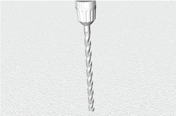
2: Perforar el fondo / madera  $\varnothing$  8 mm, hormigón según se requiera. (Nota: ¡En techados de tejas onduladas no taladrar agujeros en la parte cóncava de las tejas!)
