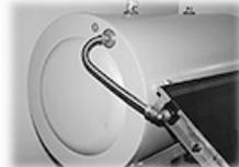
Antes de proceder al montaje de la conexión del tubo corrugado, monte el adaptador macho de 3/4" en la entrada del colector tal como se muestra en la imagen. Monte el tapón obturador de 1/2" en el depósito
